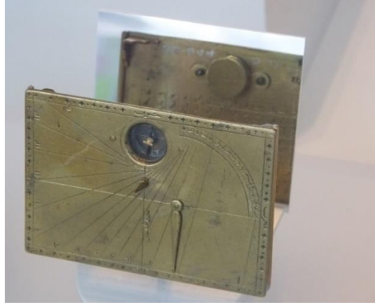
Şekil 29: İran Yatay Kadran ve Kible göstergesi [26]
