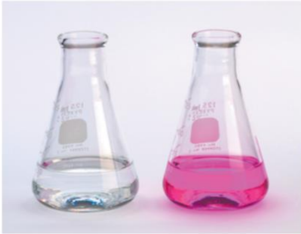
Şekil 8. Fenol ftalein indikatörünün pH değişimine karşı renk değişimi
